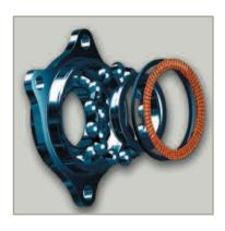
ASB® é um rolamento de roda que integra uma junta rotativa com codificação magnética integrada, capaz de ativar um sensor ativo miniatura, situado à proximidade.
