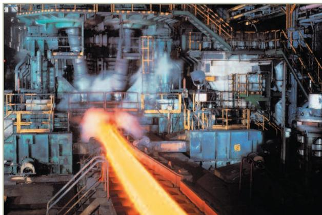
Embora as condições pelas quais passem os rolamentos sejam variáveis durante o processo, elas são sempre difíceis: altíssimas pressões (durante a laminação), temperaturas e cargas elevadas, umidade (projeção de água para resfriar as partes expostas à temperatura), vibrações e choques.
