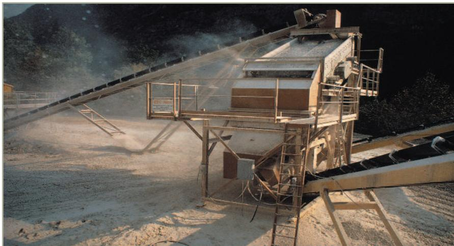
Assim, a SNR dispõe de uma ampla gama de produtos, inclusive dos rolamentos autocompensadores de rolos PREMIER em gaiola de chapa ou gaiola maciça (ou ainda "especial para peneira vibratória", a série EF800), para enfrentar as condições de funcionamento dificultadas. Os rolamentos SNR proporcionam uma solução adequada a cada etapa da preparação do minério.
