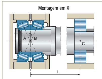
Considera-se esse mancal como constituído de um único rolamento com duas fileiras de rolos, cujo centro O é o meio da distância AB dos pontos de aplicação das cargas. A montagem de um eixo com um tal mancal é hiperestática (3 pontos de apoio: A, B, C) e somente pode ser comparada a uma montagem sobre dois mancais se a distância AB for inferior a L/5 e se a rigidez do conjunto for correta (defeito de alinhamento < 0,06°). Nos demais casos, consultar a SNR.
